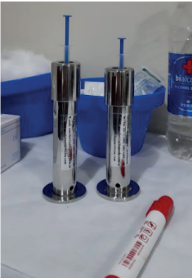
Figura 4: soportes plomados que contienen las jeringas con agujas cargadas con el coloide.
